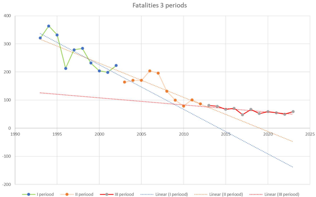
attēls 5 Laika periodi Igaunijā ar atšķirīgu CSNg bojā gājušo skaita samazināšanās tempu. Avots: D.Antov. State of the art of road network and road safety in Estonia
